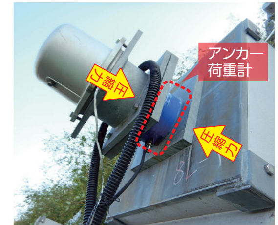
圧縮力をひずみ値で検知し、緊張力を管理
