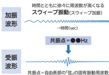
② 測定ユニットで振動波形を計測
