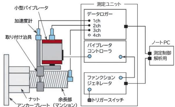
測定機器類の構成 (SEEアンカーの例)
