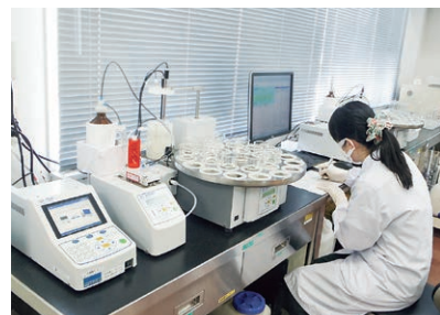
電位差滴定装置 コンクリート中の塩分濃度分析を行います。
