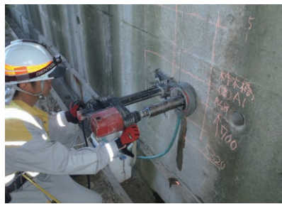
コア採取 構造物より分析用のコアサンプリングを行います。
