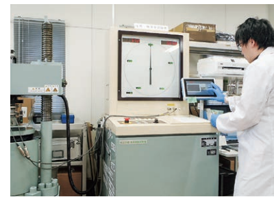
圧縮強度試験機 コンクリートの圧縮強度および静弾性係数(コンプレッソメーターによる)の測定を行います。
