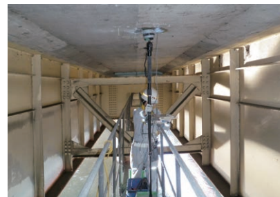
分極抵抗試験 鉄筋の分極抵抗を測定し、腐食速度を推定します。
