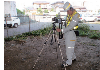
赤外線調査 遠方より構造物表面の温度差にて損傷部の位置や大きさを計測します。
