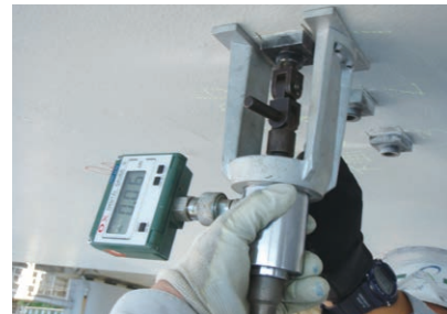
塗膜付着力試験 表面被覆材とコンクリートとの付着力を測定します。
