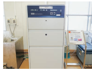
キセノン耐光性・耐候性試験 紫外線劣化を促進させコンクリート表面被覆材の耐久性を評価します。
