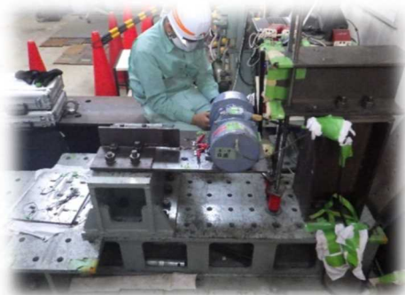
試験体を用いた疲労試験の状況
