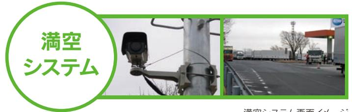
SA・PAの出入口に設置したカメラにより、通過車両のナンバーを認識し、駐車場の満車・混雑・空車を計測することができます。
