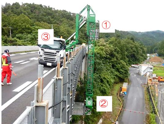
無線式カメラ装置を用いた橋梁点検状況
