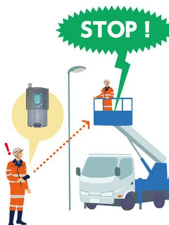
2023年度 社内 29 台全ての高所作業車へ「無線式緊急停止装置」を導入済み
